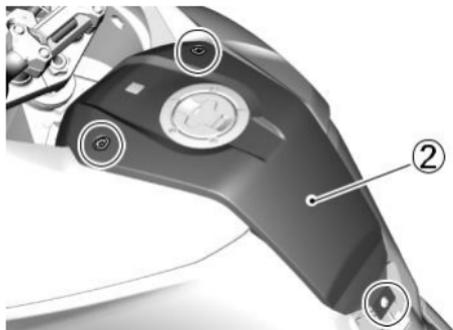
5. Retire os parafusos e fixadores. Desenganche os ganchos e remova as capas laterais direita e esquerda 3.
