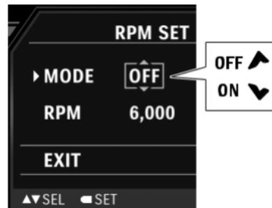
3. Pressione a chave MODE para confirmar a configuração. Se "ON" estiver definido, o indicador de rpm do motor 3 será ligado.
