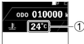
Embora a temperatura do monitor possa mostrar mudanças significativas, isso não é uma anormalidade. Uma vez que existe a possibilidade de superaquecimento se o monitor exceder 120°C (248°F), ver "EM CASO DE SOBREAQUECIMENTO (TEMPERATURA DO LÍQUIDO DE ARREFECIMENTO DO MOTOR INDICADOR LUZ ACENDER)" na página 4-3.
