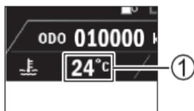
Embora a temperatura exibida possa apresentar variações significativas, isso não indica anormalidade. No entanto, caso a temperatura exibida ultrapasse 120°C (248°F), há risco de superaquecimento — consulte “EM CASO DE SUPERAQUECIMENTO (LUZ DE ADVERTÊNCIA DE TEMPERATURA DO LÍQUIDO DE ARREFECIMENTO ACESA)” na página 4-3.
