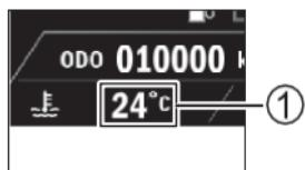
Embora a temperatura exibida possa apresentar variações significativas, isso não indica anormalidade. No entanto, caso a temperatura exibida ultrapasse 120°C (248°F), há risco de superaquecimento — consulte “EM CASO DE SUPERAQUECIMENTO (LUZ DE ADVERTÊNCIA DE TEMPERATURA DO LÍQUIDO DE ARREFECIMENTO ACESA)” na página 4-3.
