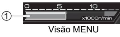
Ex: RPM configurado em 6.000 r/min
