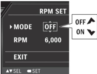
3. Pressione **MODE** para confirmar a configuração. Se “ON” estiver definido, o indicador de rpm do motor (3) acenderá.
