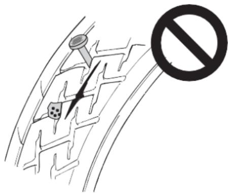
Verifique também se não há desgaste anormal na superfície de contato dos pneus. Consulte um concessionário Suzuki em caso de qualquer desgaste incomum.
