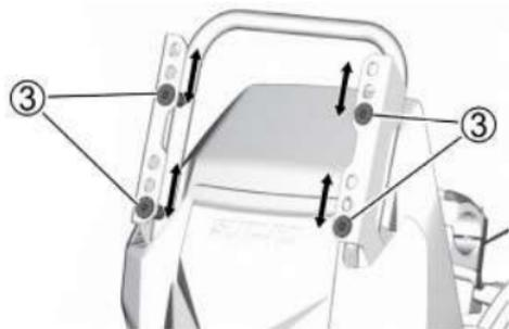
3. Reinstale o para-brisa na ordem inversa da remoção.
