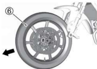
9. Coloque a roda em posição e insira o eixo da roda.
