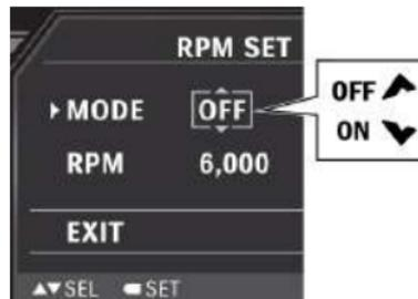
3. Pressione o botão **MODE** para confirmar o ajuste. Se "ON" for selecionado, o indicador de rotação (rpm) ③ do motor irá acender.
