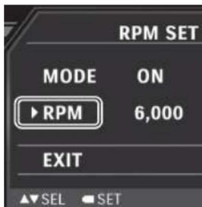
2. Selecione o valor numérico da rotação do motor usando o botão SELECT ▲ / ▼, em seguida pressione o botão MODE para confirmar o ajuste.
