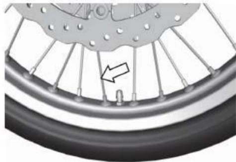
Para apertar apropriadamente os niples dos raios, aperte-os por igual com o torque especificado. Niples de raios frouxos ou excessivamente apertados pode deixar os raios com tensões diferentes resultando em distorções ou empenamento do aro da roda. Contate sua concessionária autorizada Suzuki para executar este serviço.
