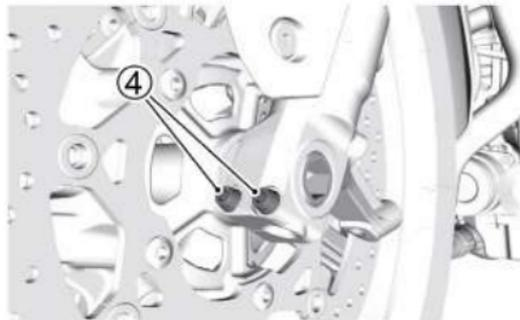
13. Reinstale as pinças do freio e o sensor de velocidade.
