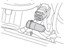
Remova o plugue e drene a água e o óleo em todas as manutenções periódicas. O plugue do dreno do filtro de ar fica situado abaixo da caixa do filtro de ar.
