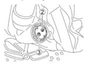
Para posicionar a mola de pré-carga na posição padrão, gire o ajustador ② no sentido anti-horário até ele parar e gire-o no sentido horário 4 voltas. Gire o ajustador no sentido horário a partir da posição padrão para aumentar a précarga da mola. Gire o ajustador no sentido anti-horário para reduzir a précarga da mola. A pré-carga da mola deve ser ajustada gradativamente para um ajuste fino da suspensão. Ajuste ambos os garfos (direito e esquerdo) para a mesma pré-carga da mola.
