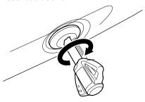
A trava do assento traseiro está localizada sob a tampa lateral esquerda. Para remover o assento traseiro, insira a chave de ignição na fechadura e gire-a no sentido horário. Levante a parte dianteira do assento e deslize-o para frente.
