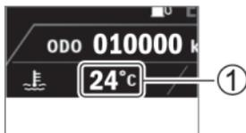
A exibição de grandes variações de temperaturas não é considerada uma situação anormal. No entanto caso a temperatura ultrapasse 120°C (148°F) existe a possibilidade de superaquecimento, veja “NO CASO DE SUPERAQUECIMENTO (LUZ INDICADORA DE ADVERTÊNCIA DA TEMPERATURA DO LÍQUIDO DE ARREFECIMENTO DO MOTOR ACENDE)” na página 4-3.
